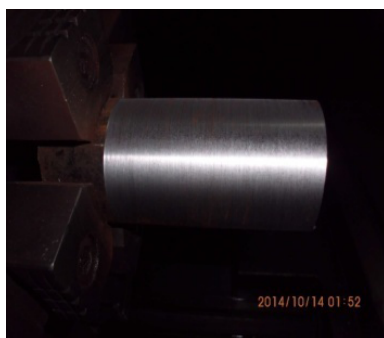
Gambar 8 : Bahan uji coba S45C
