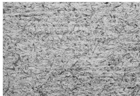
Gambar 1 Struktur Mikro Pembesaran 500X Setelah Proses Quenching Mateial Baja SUP-9 waktu tempuh 31 detik
