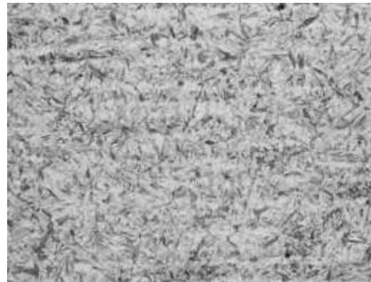
Gambar 5 Struktur Mikro Pembesaran 500X Setelah Proses Quenching Material Baja SUP-9 waktu tempuh 37 detik
