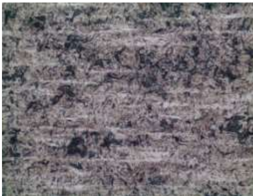
Gambar 18 Struktur Mikro Pembesaran 500X Setelah Proses Quenching Material Baja SUP-11AM waktu tempuh 55 detik
