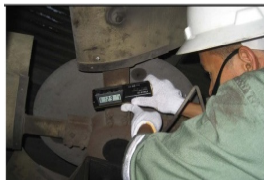
Aktivitas pengukuran angle blade di lapangan
