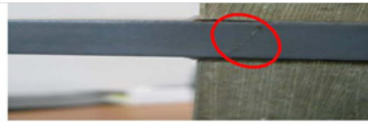
Gambar Kondisi Cooler Blade setelah kegagalan
