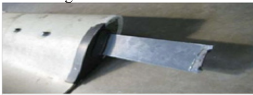
Gambar Temuan lapangan patahnya Cooler blade
