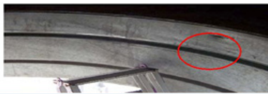
Gambar Temuan lapangan patahnya Cooler blade
