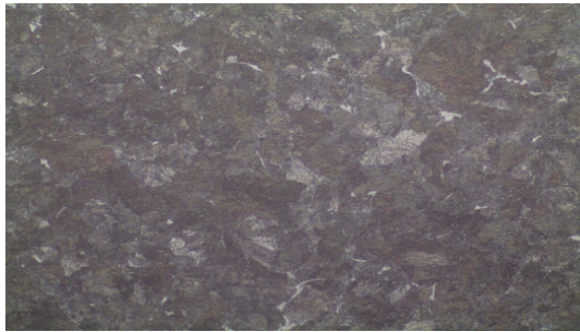
Gambar 4.2 Foto Struktur Mikro RAW Material Baja SUP 9 Produksi TKJY (Taikong)
