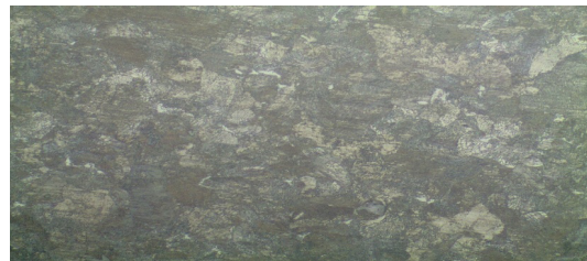
Gambar 4.1 Foto Struktur Mikro RAW Material Baja SUP 9 Produksi Jatim Stell (Indonesia)
