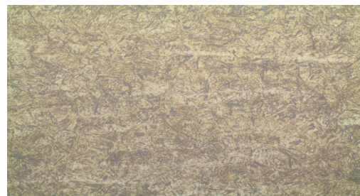
Gambar 4.6 Foto Struktur Mikro Setelah Proses Quenching Material Baja SUP 9 Produksi IBPM (Indonesia).
