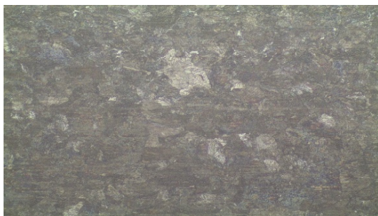
Gambar 4.3 Foto Struktur Mikro RAW Material Baja SUP 9 Produksi IBPM (Indonesia)
