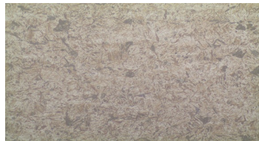
Gambar 4.5 Foto Struktur Mikro Setelah Proses Quenching Material Baja SUP 9 Produksi TKJY (Taikong).
