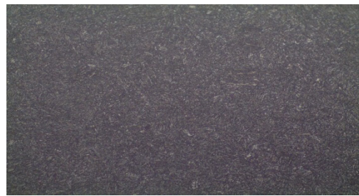
Gambar 4.9 Foto Struktur Mikro Setelah Proses Tempering Mateial Baja SUP 9 Produksi IBPM (Indonesia).
