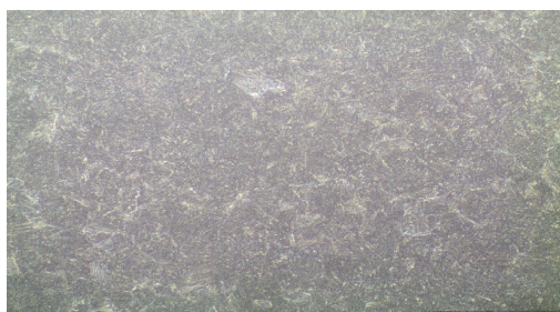
Gambar 4.7 Foto Struktur Mikro Setelah Proses Tempering Mateial Baja SUP 9 Produksi IBPM Surabaya (Indonesia).
