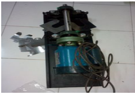
Gambar 4.3 Simulasi Pengukuran Mesin Berputar (Pengukuran Spectrum Vibrasi dan Perbedaan Phase )
