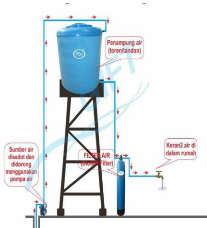
Gambar 5. Pemasangan filter air dengan tandon air
