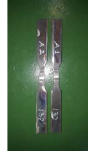
(a) (b) Gambar 4.4. Bahan uji arus 130 A setelah diuji tarik. (a) Heat Input 6.52 kJ/mm dan (b) Heat Input 5.65 kJ/mm
