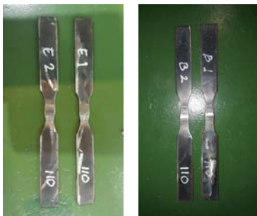
(a) (b) Gambar 4.2. Bahan uji arus 90 A setelah diuji tarik. (a) Heat Input 4.66 kJ/mm dan (b) Heat Input 8.45 kJ/mm
