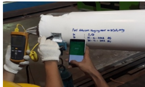
Gambar 4.3 Adhesive Hanging Test dengan waktu max 10 menit
