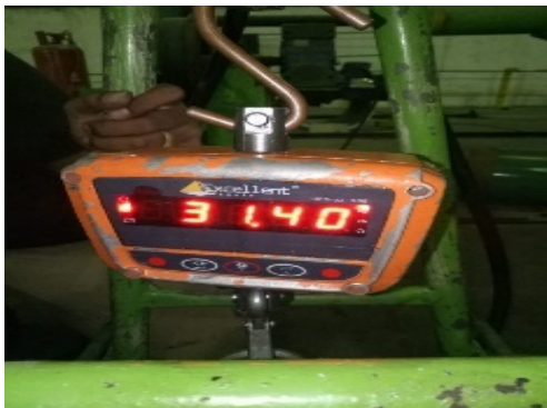
Gambar 4.2 Uji Daya Lekat/ Peel Test pada temperatur 95°C
